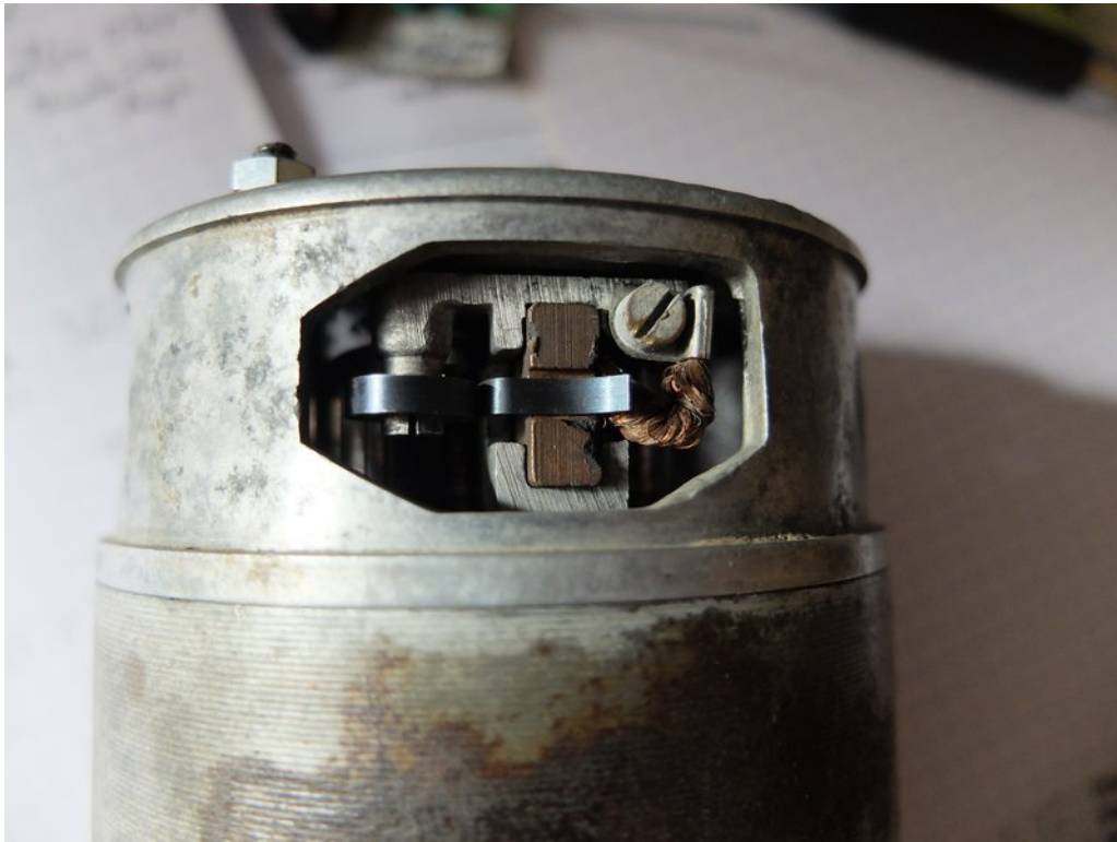
Réserve d'usure des balais : 7mm au balai le plus usé
