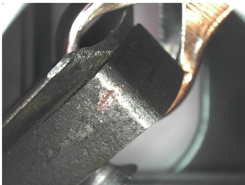
Après limage des excroissances, il reste encore des traces de cuivre incrusté
