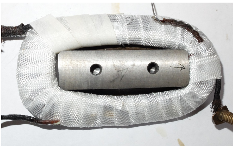
Bobine 4 elle comporte un fil isolé, qui traverse, sans contact, pour relier le balai à la borne DYN
